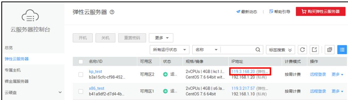
步骤 5 打开自己电脑上的 putty 工具，将获取到的弹性 IP 地址写入 “Host Name (or IP address)处”，然后点击 “Open” 若有提示框，选择 “yes”，然后输入用户名 root 以及密码，登录 kp\_test 服务器。
